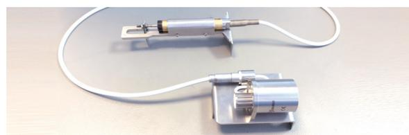
Le CeriDry Split permet d'affectuer la corrélation entre l'évolution du taux d'humidité et de la température de l'air avec la rétraction des briques, tuiles ou céramiques lors du procédé de séchage industriel.
