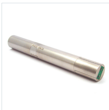
PicoVACQ Th avec pack pile 015PW et micro-connecteur de type K
