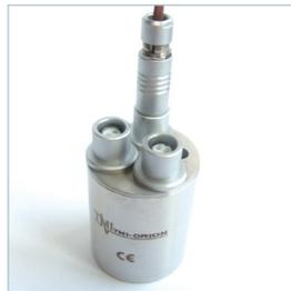
**NanoVACQ 3Th avec connecteurs cylindriques et un thermocouple connecté**
