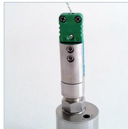
**NanoVACQ 1Th avec un micro connecteur et un thermocouple de type K connecté**
