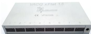
**VACQ xFlat 1.8 avec connecteurs pour thermocouples type T**
