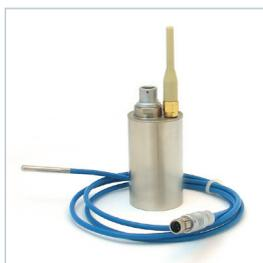
**NanoVACQ 1Tdi Radio avec connecteur Fischer Connectors® et sonde Teflon® PFA déconnectée**
