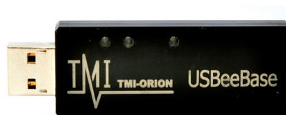
L'émetteur-récepteur USB est une interface de communication radio 2.4 GHz reliant le PC aux enregistreurs radio ou FullRadio de TMI-Orion.
