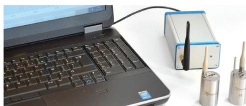
L'émetteur-récepteur est une interface de communication radio 2.4 GHz reliant le PC aux enregistreurs radio ou FullRadio de TMI-Orion.
