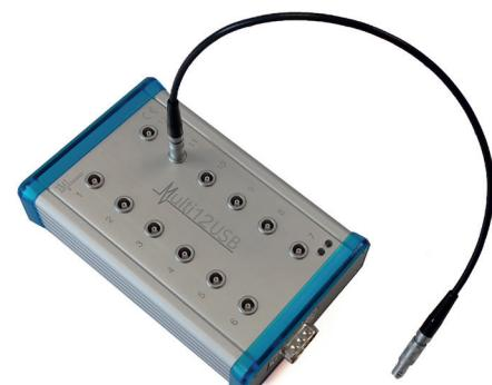
Il est possible de connecter les interfaces Multi12USB et MOUSB entre elles pour atteindre jusqu'à 96 enregistreurs gérés simultanément.
