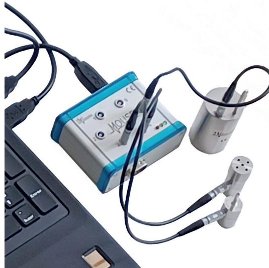
Les interfaces de communication filaires relient l'ordinateur, sur lequel est installé le logiciel Qlever, à l'enregistreur filaire ou à l'enregistreur/transmetteur radio TMI-Orion.
