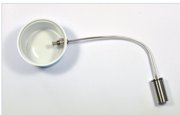
PicoVACQ PT 和同机身分离的压力传感器
